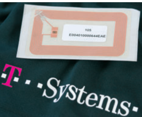
RFID-Chips senden Daten per Funkwellen an Lesegeräte.
