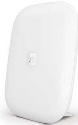
A02: Eine Variante der Home Base 2.0 enthält neben ZigBee Pro auch das Z-Wave Funkmodul.
