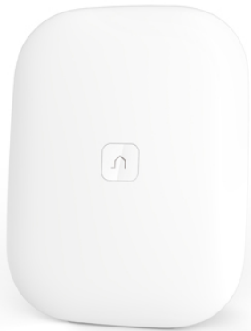
A01: Die neue QIVICON Home Base 2.0 wird mit den Protokollen HomeMatic, Homematic IP sowie ZigBee Pro ausgeliefert, DECT ULE ist vorbereitet.
