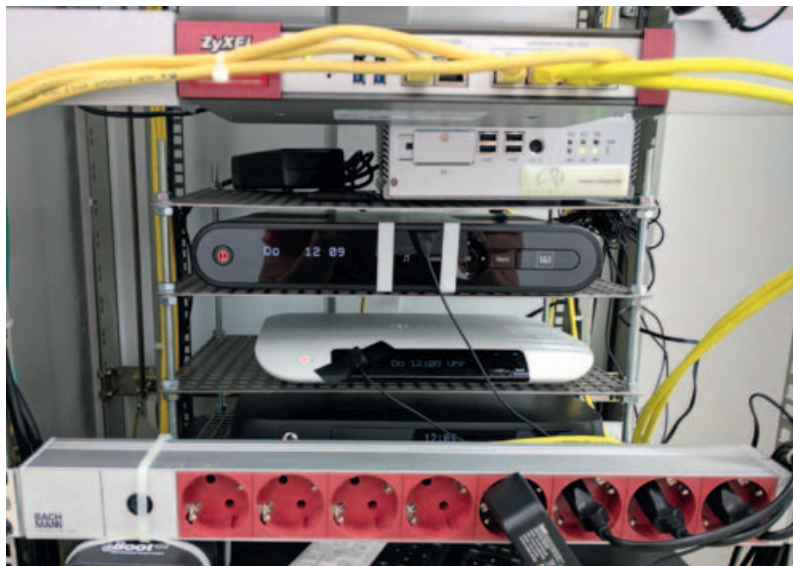
Automatisch zappen: Die Mess-Systeme von zafaco steuerten die Original-Set-Top-Boxen der Anbieter vollautomatisch. Gleichzeitig erfassten, protokollierten und analysierten sie die von ihnen gelieferte Videoqualität.
